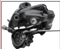
**2** Disassemble the original rear derailleur cage and pulleys.
